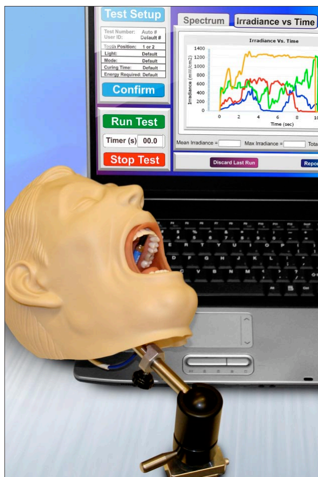
图: Blue Light's MARC 系统利用海洋光学USB4000 光谱仪来精确监控牙齿的光治疗
