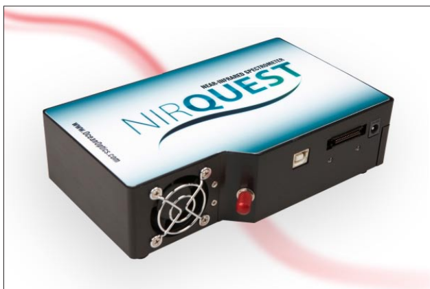
图: 海洋光学NIRQuest512-2.2 近红外光纤光谱仪尺寸小，且测量范围可达900-2200nm
